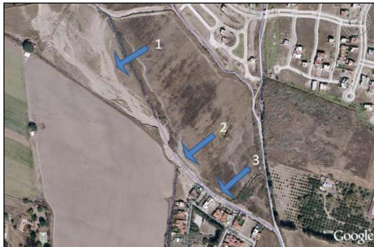
Foto 2-28. Transecto de un canal modificando anárquicamente que alterará el patrón superficial del agua: 1) Zonas nuevas de escurrimientos y depositacion; 2) Cara activa con mayor erosión; 3) Viviendas afectadas por la erosión lateral.
