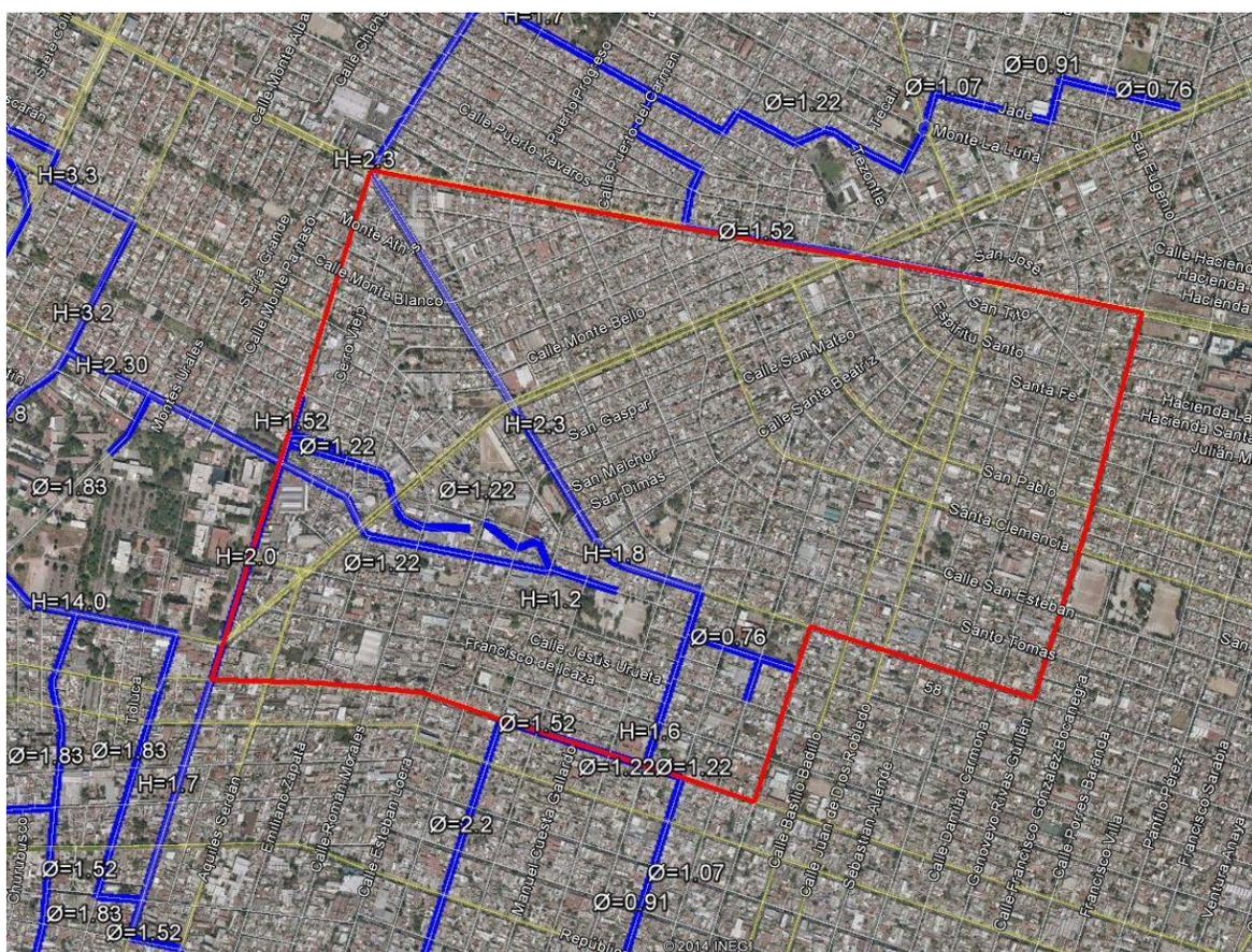
Ilustración 16. Colectores principales dentro del municipio de Guadalajara.
