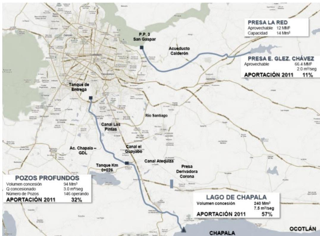
Ilustración 10. Esquema general de abastecimiento de ZMG.
