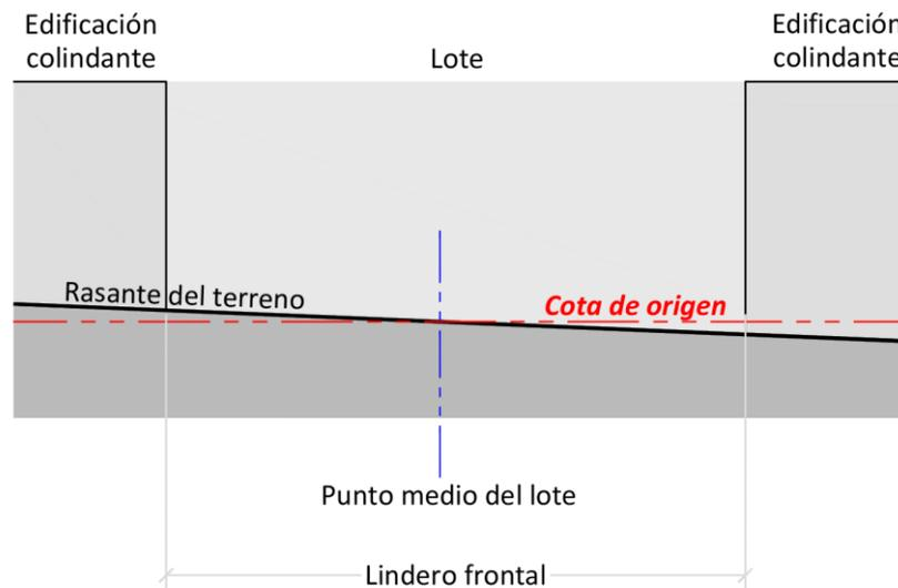
3. En calles con pendiente longitudinal mayor a diez por ciento (10%), si la longitud del lindero frontal es mayor a veinte (20) metros, se podrá descomponer la fachada en fracciones. Para cada fracción se aplicará una cota de origen y se evaluarán las alturas de manera independiente para cada sección. El número de fracciones será el menor posible, salvo que justificadamente por adaptación al entorno circundante sea conveniente incrementar el número de ellos.
