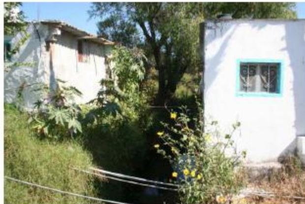
**Figura No.09** Vivienda asentada en las márgenes del cauce, ocasionando drásticamente la disminución de la anchura, aumentando la probabilidad de represamientos momentáneos. Se considera necesario rectificar la sección y aumentar la capacidad por lo menos en un 50%.
