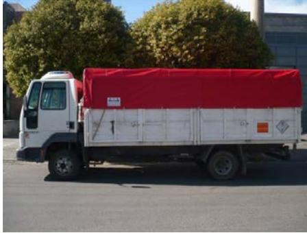
**Figura 11. Correcta colocación de lonas en vehículo**
