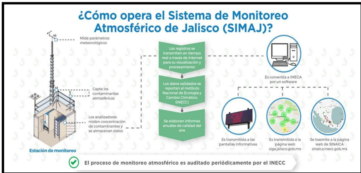
Figura 2. Operación del Sistema de Monitoreo Atmosférico
