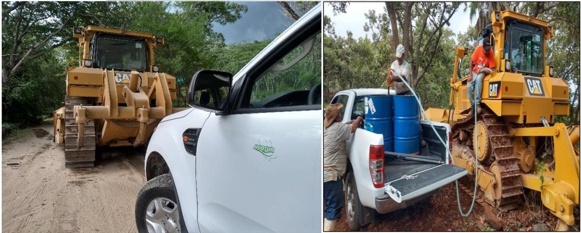
Imagen. Descarga de Maquina y abasto de combustible.
